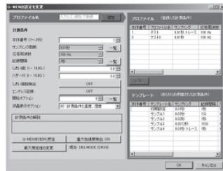
上記の設定では、G-MENは測定開始を実行すると、開始オプション5秒後から始動し1秒で1データ記録します。内容は記録間隔1秒間の中で10msecごとにサンプリング計測した100個のデータ中で、X・Y・Z軸のそれぞれのピークG値を記録し、温度・湿度も記録します。
